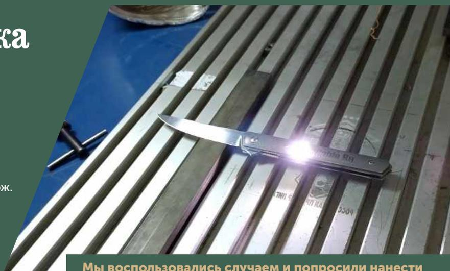
Мы воспользовались случаем и попросили нанести маркировку с логотипом RusCable.Ru на нож. На фото процесс лазерной гравировки
